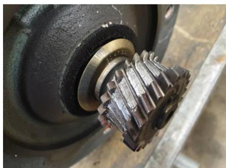
Am 21.10.2019 wurde festgestellt, dass die Rücklaufschlamm Schnecke der Strasse 2 nicht mehr drehte und dies obwohl der Motor normal lief. Es musste also von einem Schaden im Getriebe ausgegangen werden. Da der Getriebemotor mit fast 200'000 Betriebsstunden nicht mehr den neusten Energieanforderungen entsprach, hatten wir bereits eine Ersatzantriebseinheit am Lager, diese konnte innerhalb einer Stunde gewechselt werden.
