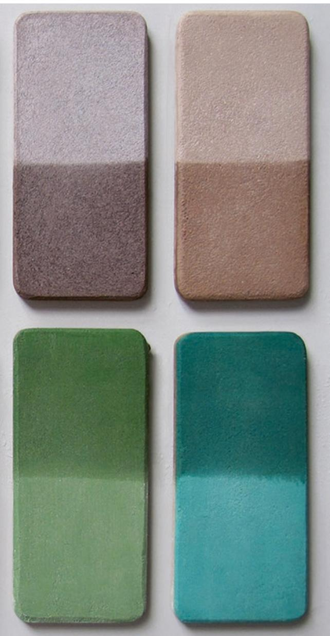
*Abb. 3* Kalkfarben sind saugfähig und können auf Witterungsbedingungen – beispielsweise feuchte Luft – flexibel reagieren. Die dargestellten Kalkfarbmuster sind auf der dunkler in Erscheinung tretenden Seite mit Wasser benetzt. Dadurch gewinnen die Farben an Intensität und Leuchtkraft, ähnlich Kieselsteinen, die mit Wasser benetzt werden. Auf Fassaden ist dies ein gewünschter Vorgang, weil die Farben dadurch lebendig wirken.
