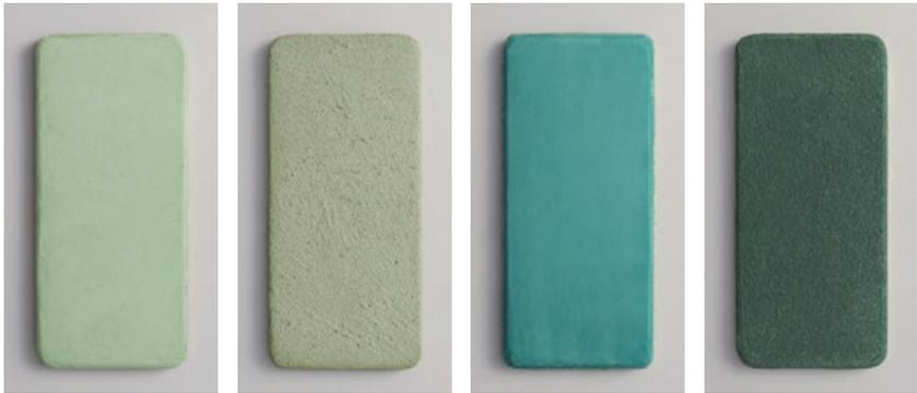
Abb. 7 Kalkfarbe – Kalkschlämme – Kalkfarbe al fresco – Kalk-Caseinfarbe (von links nach rechts). Gleiche Pigmentierung des Anstrichs, aufgetragen in verschiedenen Techniken.
