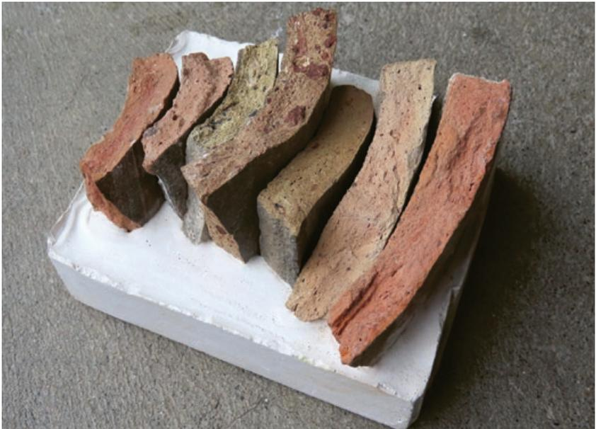
Abb. 11 Gebrannter Ton zeigt sich je nach Herkunft, Zusammensetzung und Brenndauer in farblich unterschiedlichen Ausprägungen.
