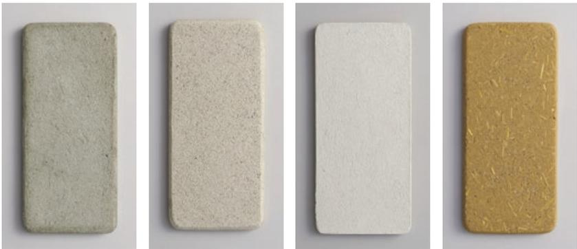
*Abb. 2* Zementputz – hydraulischer Kalkputz – Sumpfkalkputz – Lehmgrundputz mit Stroh (von links nach rechts). Seit Jahrhunderten insbesondere auf Aussenfassaden wichtige mineralische Verputzarten. Sie werden heute im Grundsatz unverändert im qualitativ anspruchsvollen und ökologisch nachhaltigen modernen Hochbau verwendet.
